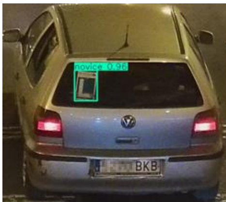
Visión artificial. Modelo de detección de logos. Clasificación alternativa de vehículos
